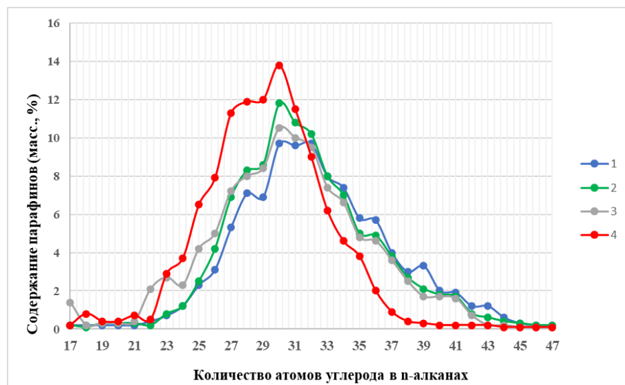
Рисунок 18- Молекулярно-массовое распределение парафинов, содержащихся в АСПО, выделившихся на «холодном» стержне (температура стержня +6°С) из нефти Кумколь при температуре нефти 50 (1), 40 (2), 30 (3) и 20 (4) °С
